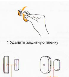
Во время установки, постарайтесь максимально выровнять уровень расположения основного датчика и магнита по специальной отметке
